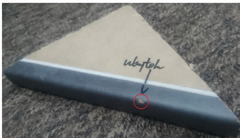
Rys. 25 Poglądowe zdjęcie ubytku
